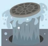
**答** 平成以降は、特に雨水が入る合流管や雨水専用管は一定量溜まったらロックがかかり、若干浮き上がることでエアアーが抜ける浮上防止型を設置している。
